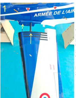
③如图3红圈所示,机翼机身对接到位后,在机身下表面有颗孔,用2.5六角螺丝刀插入,用适当的力拧紧。
